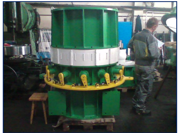
Ryc.1 Turbina podczas finalnego składania w firmie Metex
