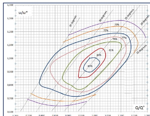
Ryc.3 Diagram sprawności z testów modelowych.
